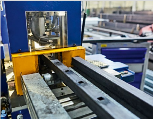
DĚROVÁNÍ PODÉLNÝCH NOSNÍKŮ PLOTOVÝCH POLÍ.
